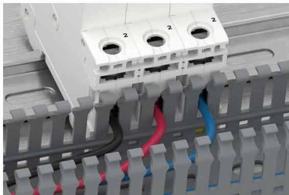
Перфорация шаг перфорации совпадает с шагом вывода контактов автоматических выключателей
